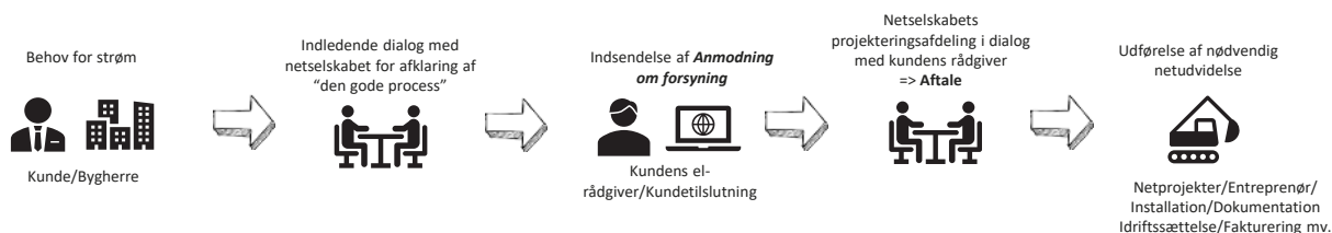
Figur 1. Illustration af proces for tilslutning af nyt elforbrug til elnettet (kilde: Radius Elnet/Dansk Energi)
